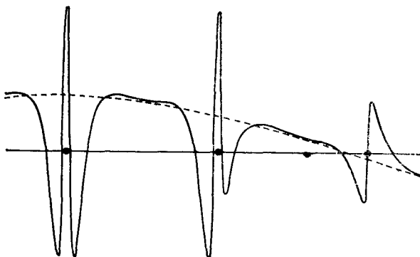
Фиг. 51. Волновая функция электрона в твердом теле.
