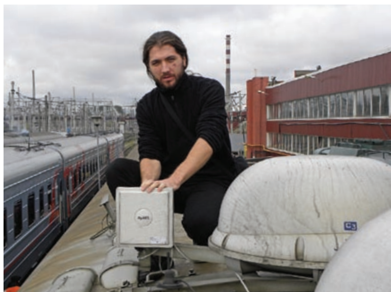
► Придываем Yota-антенну на крыше поезда. Справа — спутниковые тарелки (ближняя — ТВ, дальняя — Интернет). Здание — ремонтное депо, Санкт-Петербург.
