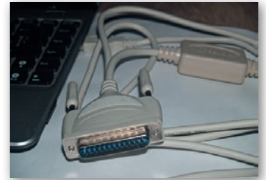
► Переходник USB-Serial (у нас — 25-контактный) превратит нетбук с Linux в центр управления оборудованием.
