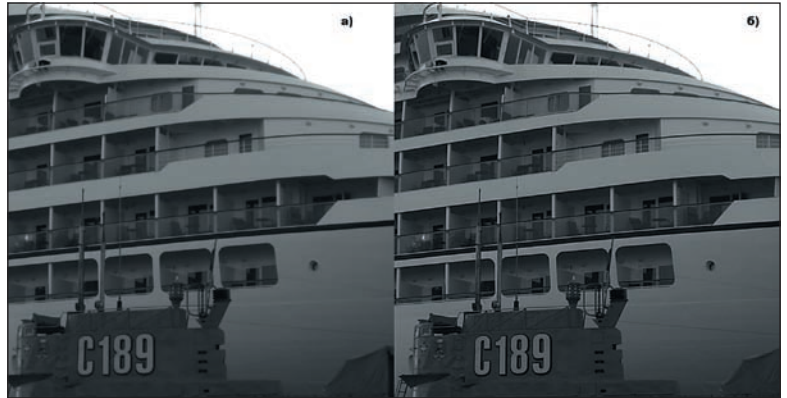
► Рис. 5. Результат компенсации ФПМ фотокамеры для стандартного режима съемки: а) исходное фотоизображение (Blue), б) результат восстановления.
