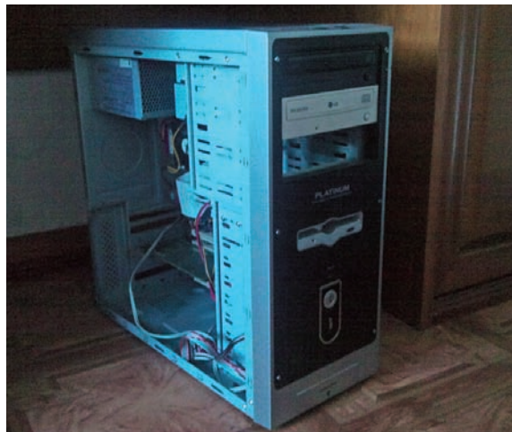
► Рис. 2. В корпус Modecom Platinum можно установить более 9 жестких дисков.
