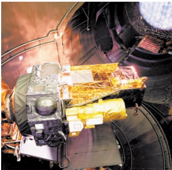
Станция «Интеграл». Желтый цилиндр – детектор SPI с активной (антисовпадательной) защитой в 500 кг весом, которая могла бы стать прекрасным спектрометром гамма-всплесков. Рисунок Европейского космического агентства (ESA)
