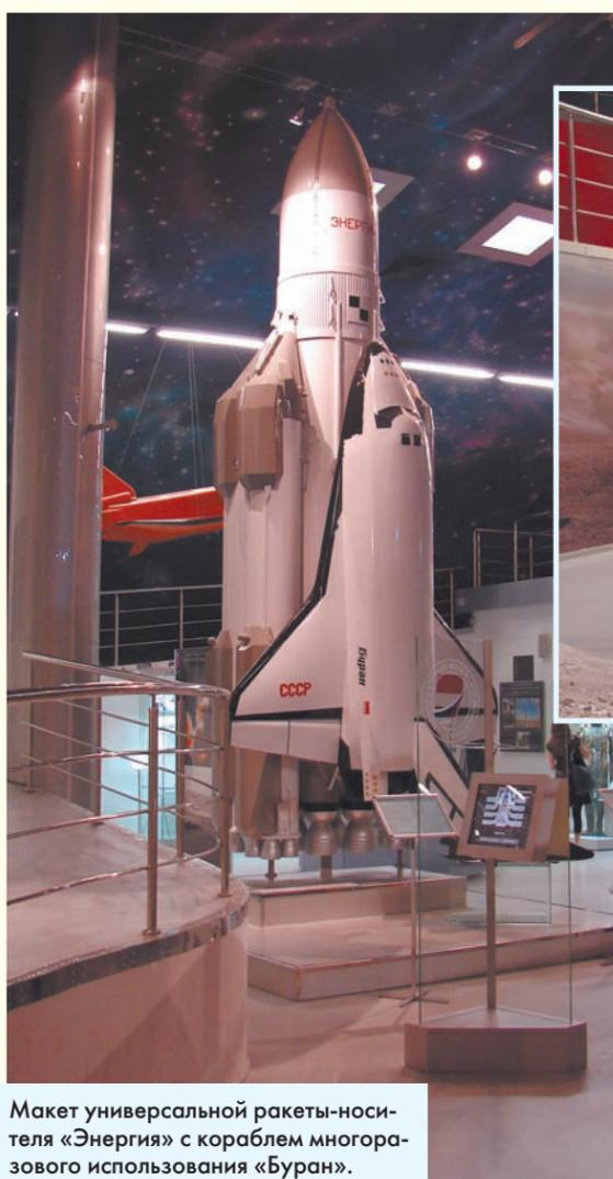
Макет универсальной ракеты-носителя «Энергия» с кораблем многоразового использования «Буран».
