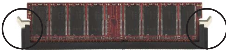
Рис. 9. Модуль DIMM после установки
