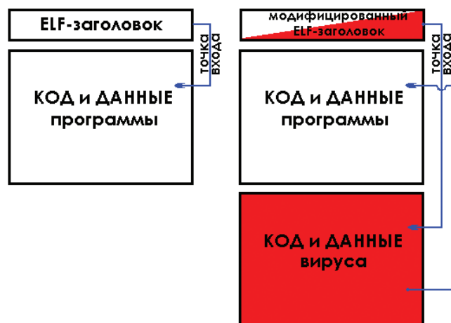
Рисунок 3. Типовая схема заражения исполняемого файла путем расширения его последней секции
