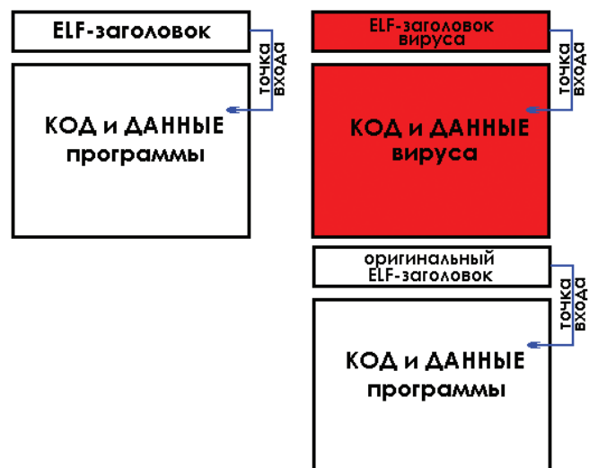
Рисунок 1. Типовая схема заражения исполняемого файла путем его поглощения
